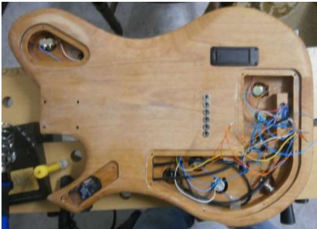
Figura 118: Montagem do controlador MIDI (parte traseira)
