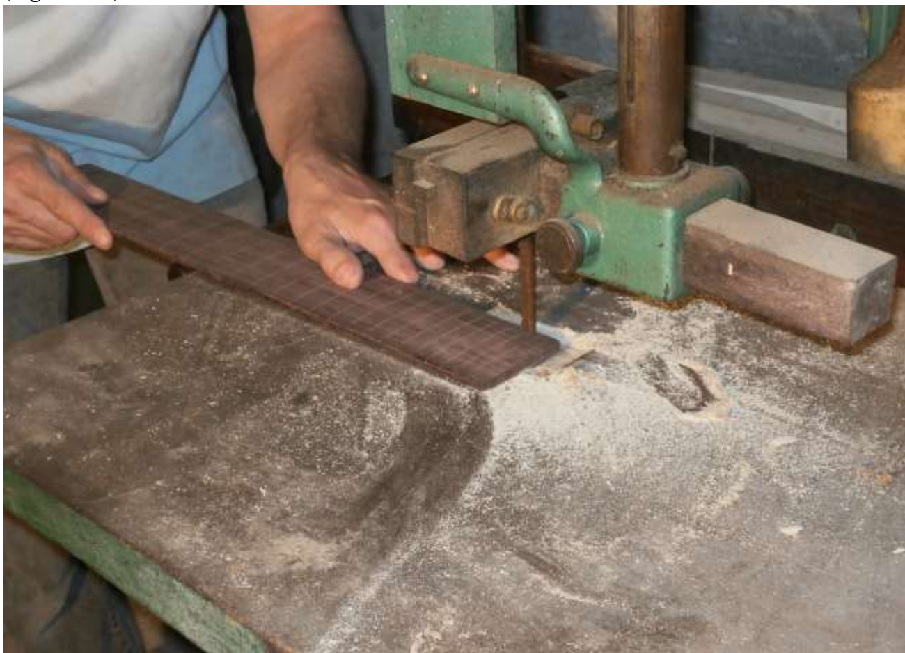
Figura 105: Corte do excesso na madeira da escala
