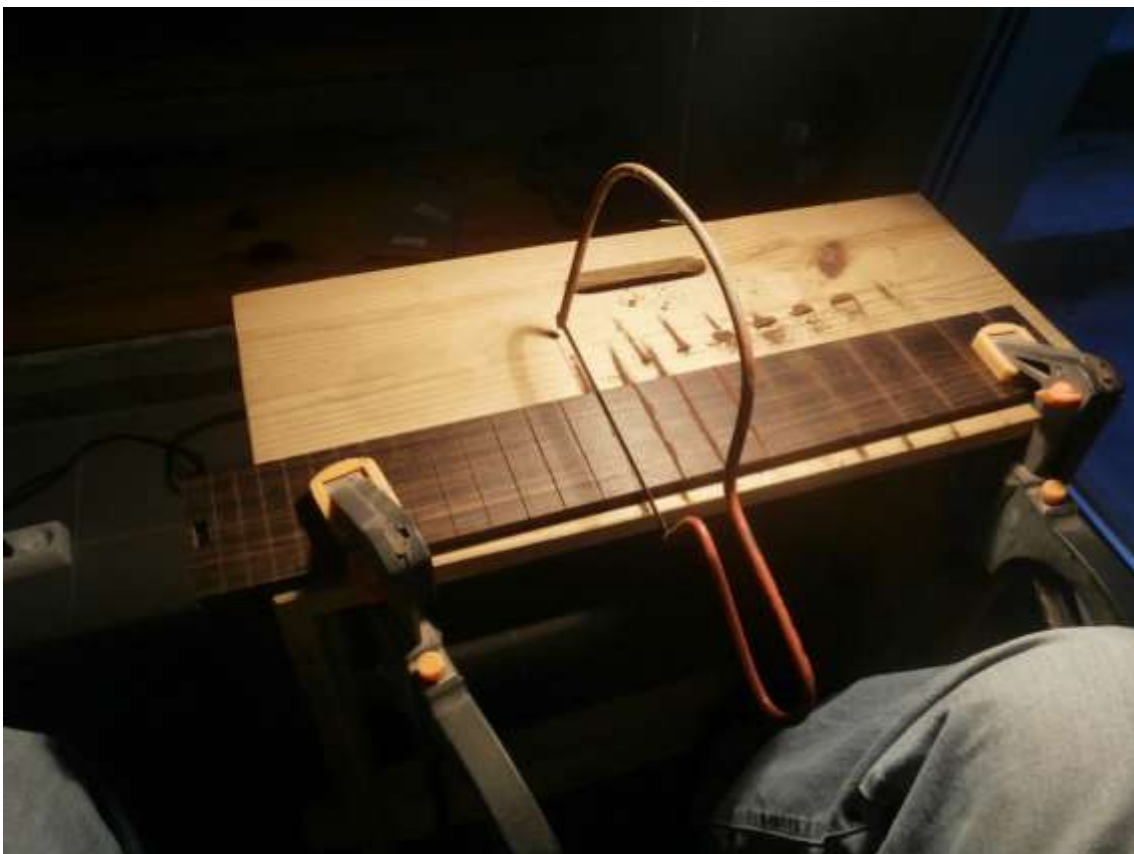
Figura 102: Abertura das cavidades para os trastes
