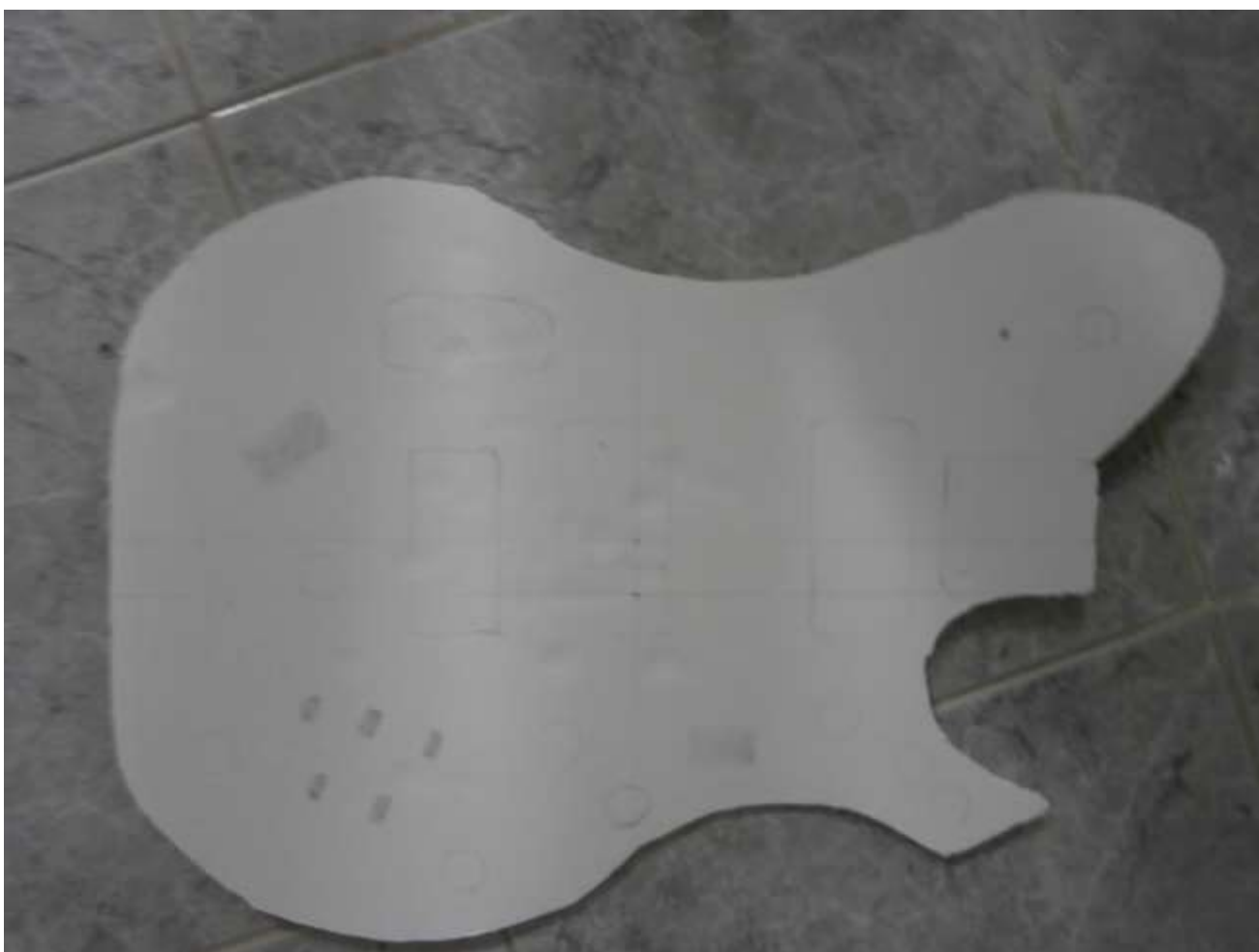
Figura 86: Primeiro molde do corpo com todos os componentes desenhados
