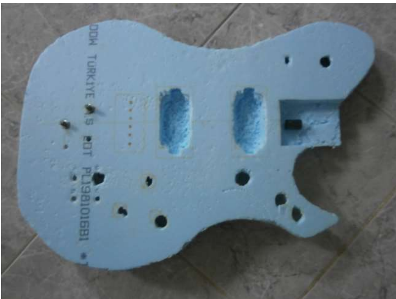
Figura 88: Protótipo construído em roofmate (já sem a maioria dos componentes da guitarra)
