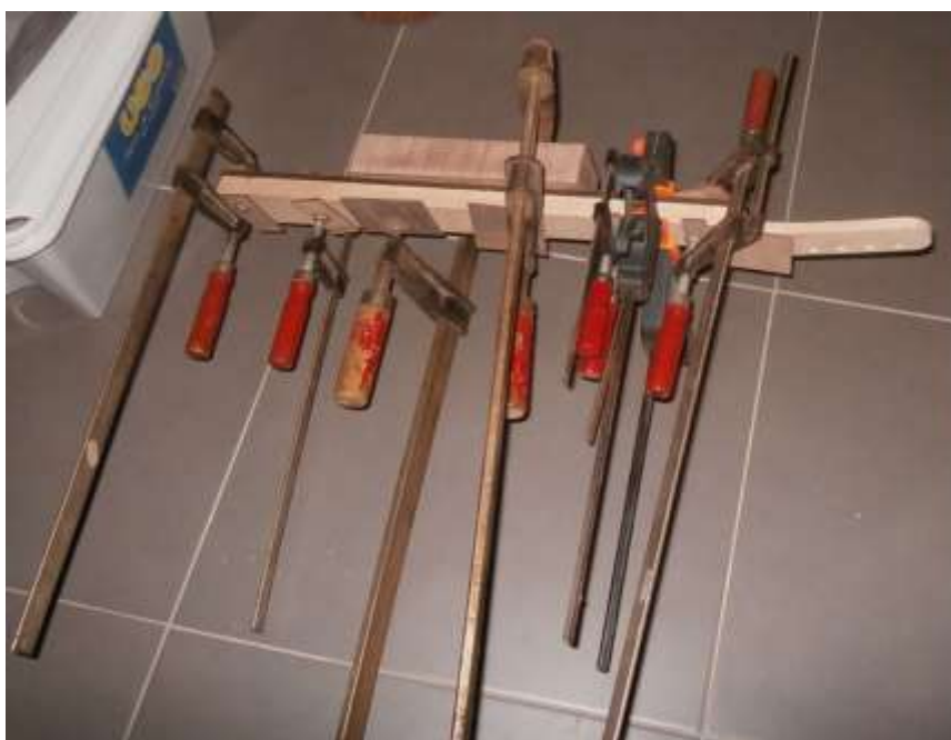
Figura 106: Grampos a segurar as madeiras do braço para que a cola secasse e as mesmas unissem corretamente
