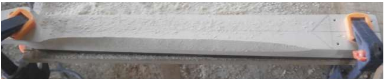
Figura 109: Início da escultura do arredondamento na parte traseira do braço
