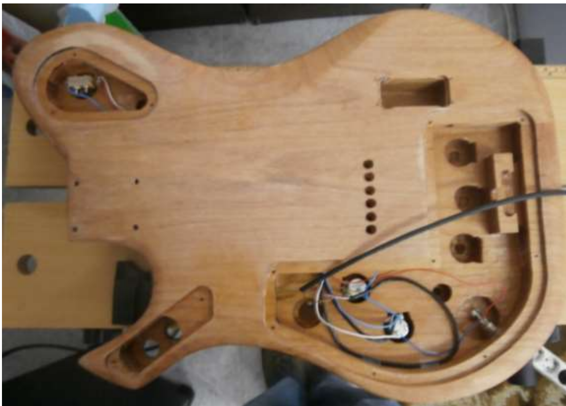
Figura 116: Montagem do circuito elétrico da guitarra (parte traseira)
