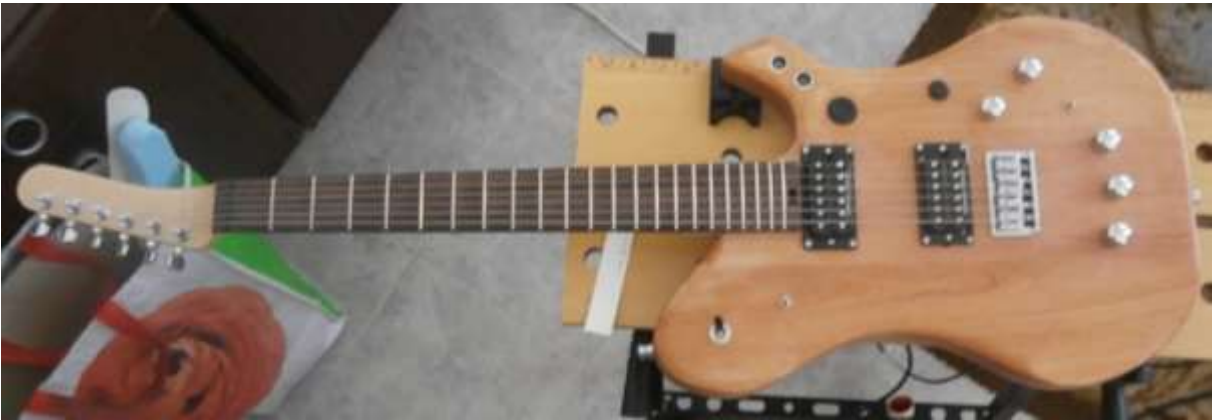
Figura 121: Colocação das cordas
