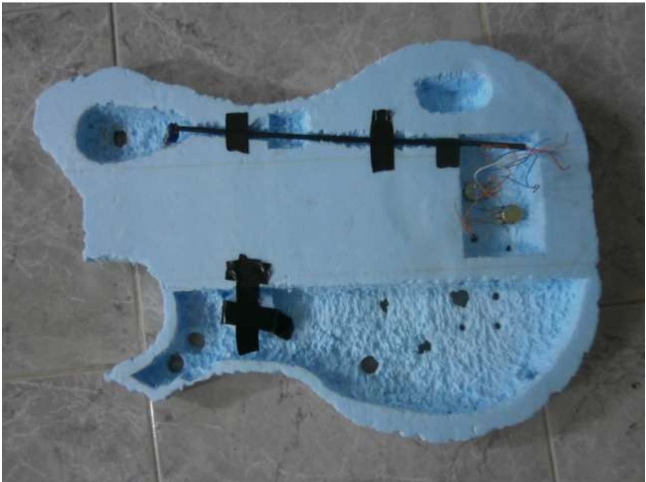
Figura 89: Protótipo construído em roofmate - parte traseira (já sem a maioria dos componentes)
