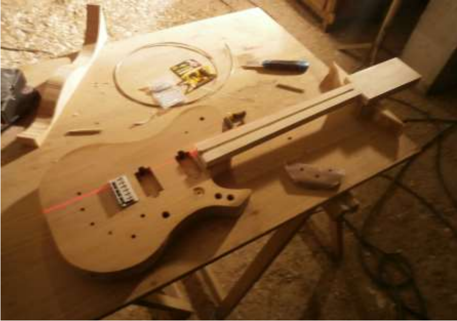
Figura 99: Braço com afinamento já pronto e desenho do seu encaixe no corpo
