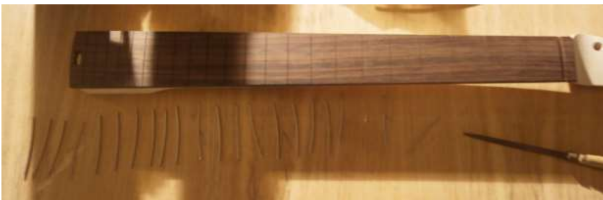
Figura 113: Corte e organização do fio de traste para posterior colocação na madeira
