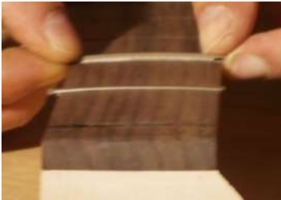
Figura 114: Colocação do traste
