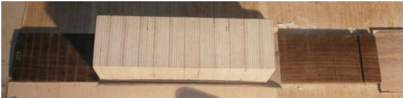
Figura 103: Lixa construída para fazer o ângulo de 12 polegadas na escala
