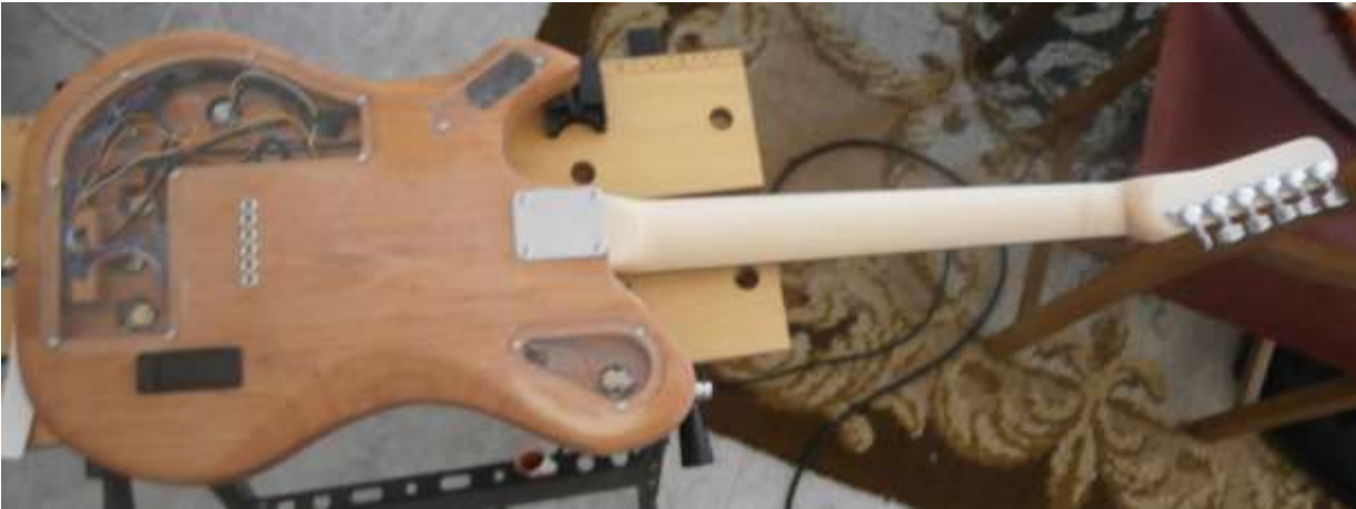
Figura 120: União do braço com o corpo e tampas colocadas
