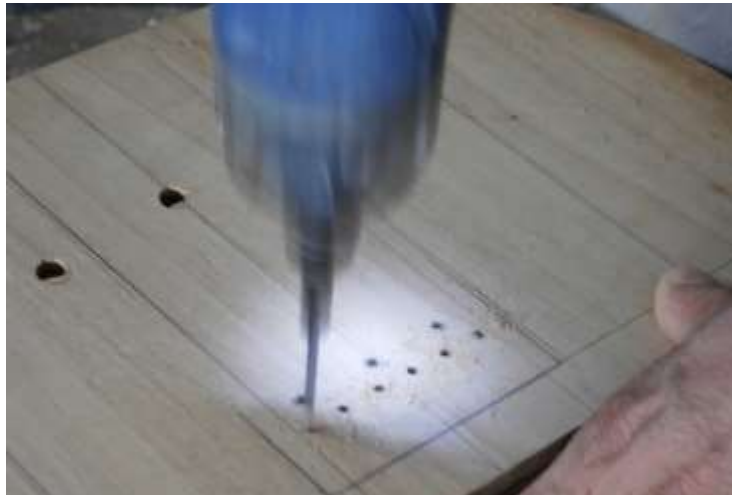
Figura 108: Perfurações da ponte para aparafusar a mesma e para a passagem das cordas
