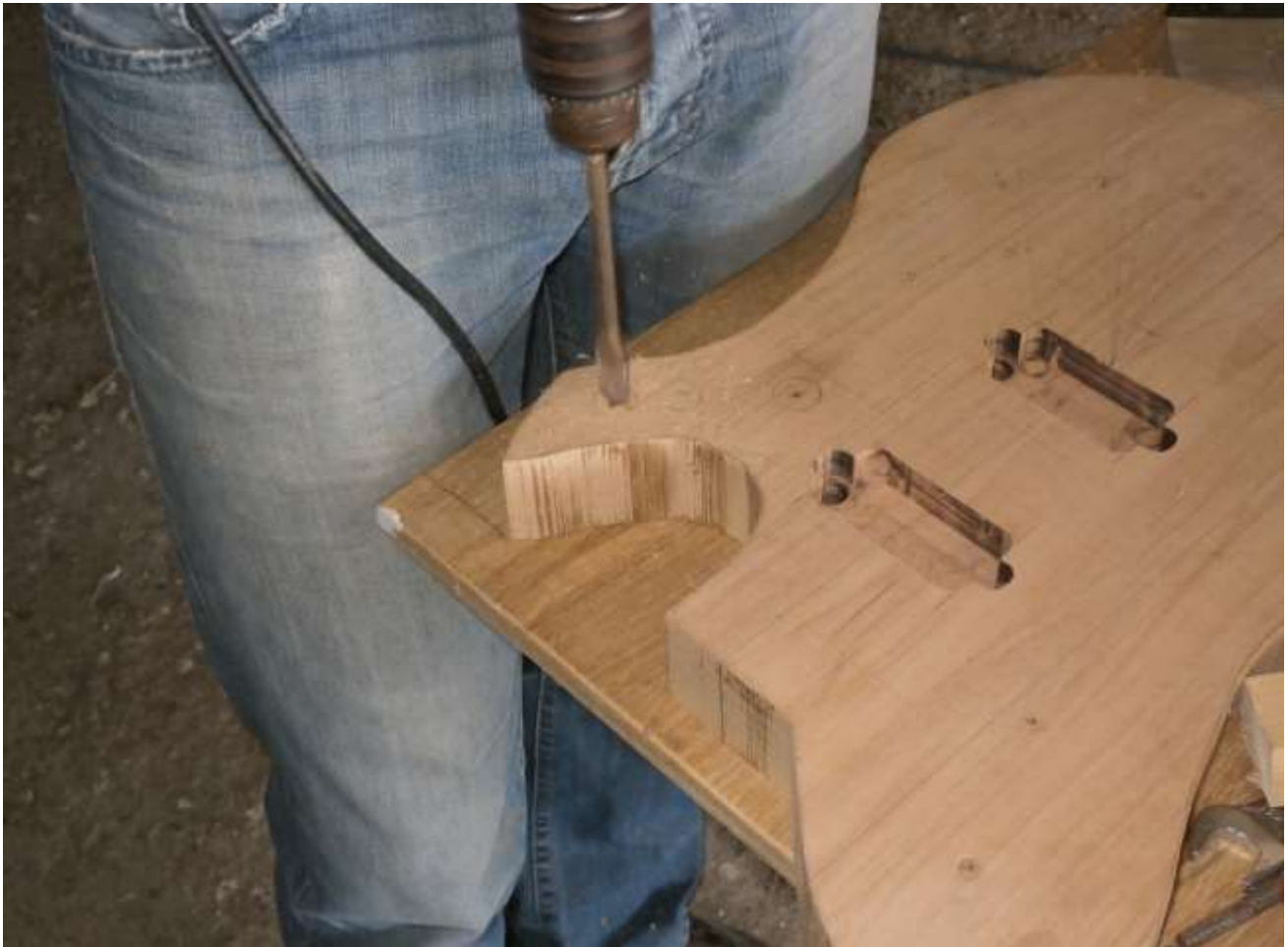
Figura 94: Perfuração para colocação do sensor de proximidade
