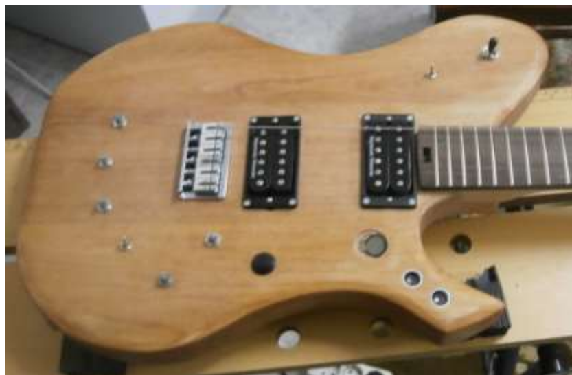
Figura 119: Montagem do controlador MIDI (parte frontal)
