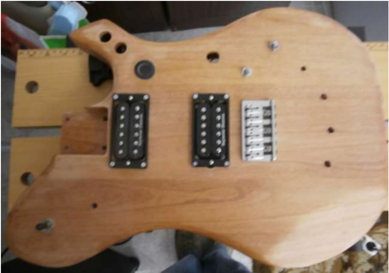
Figura 117: Montagem do circuito elétrico da guitarra (parte frontal)
