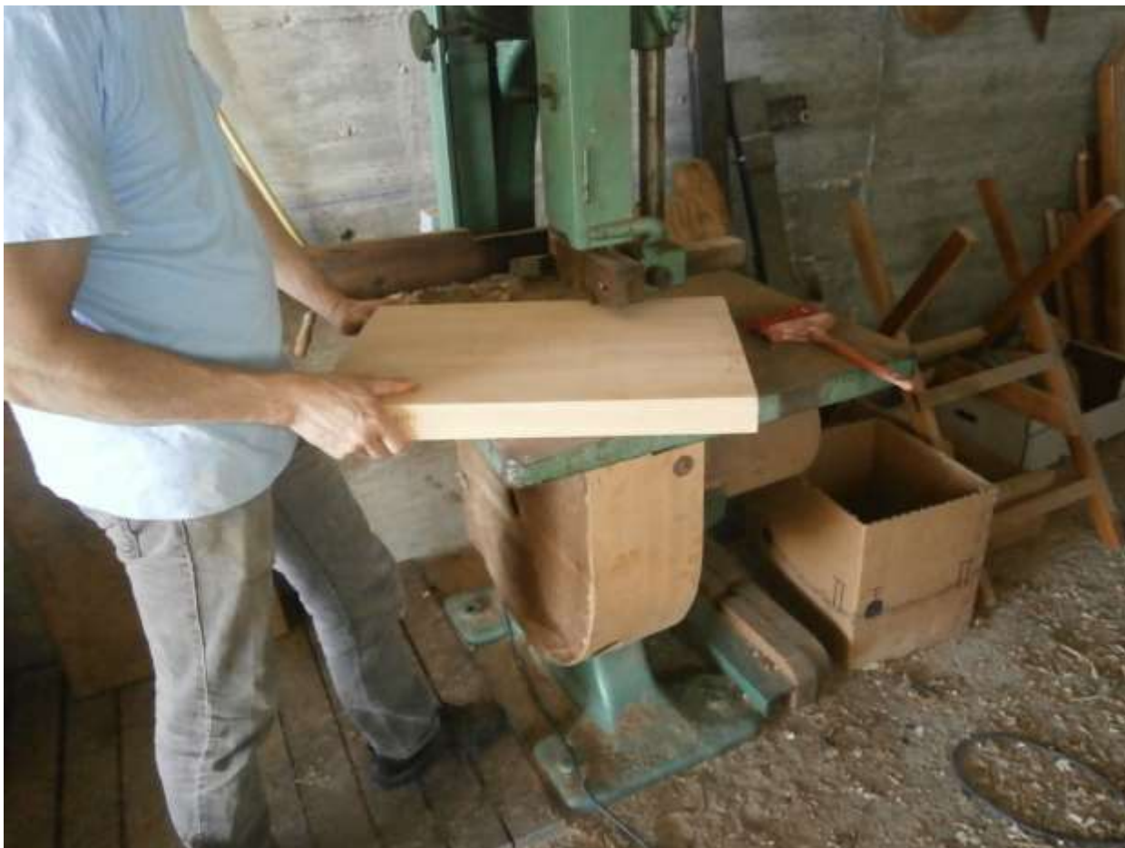
Figura 93: Corte do corpo
