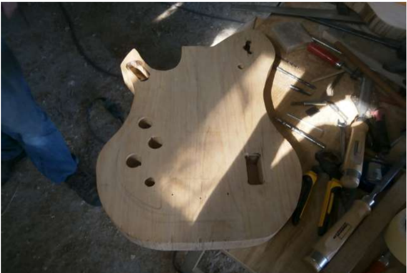
Figura 96: Várias cavidades já alargadas e já testado o encaixe dos componentes nas mesmas
