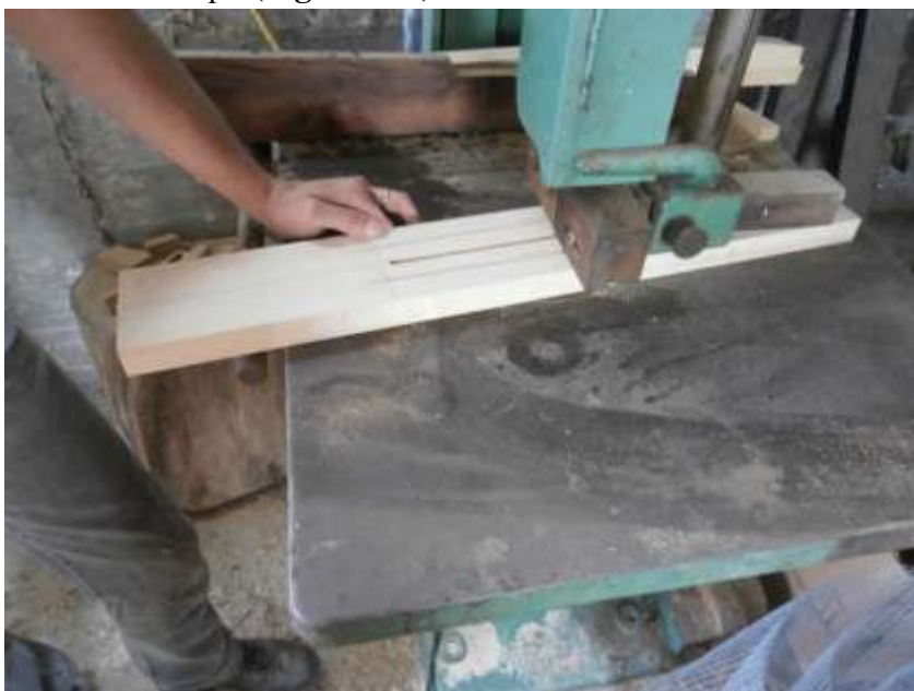
Figura 98: Corte do braço
