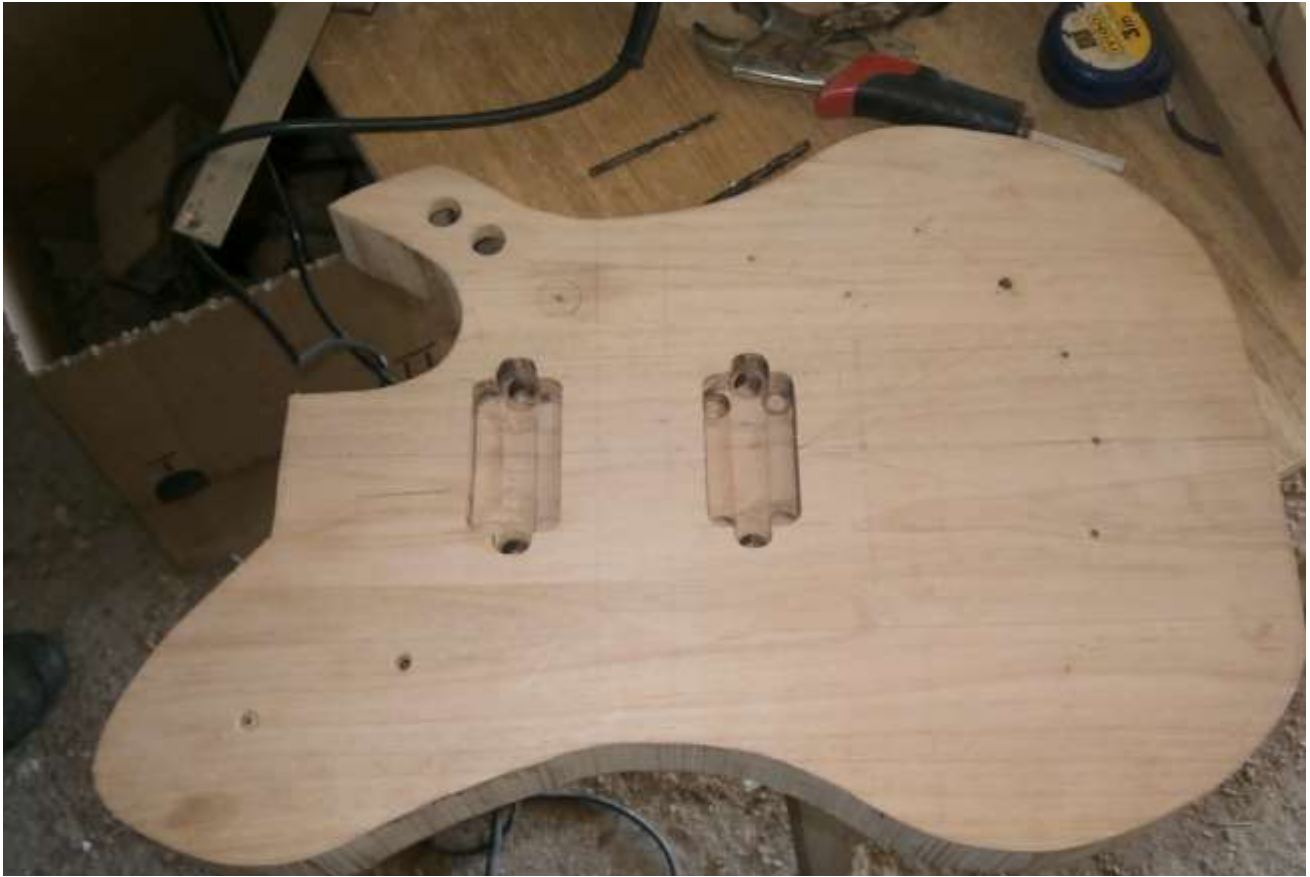
Figura 95: Perfurações e caixas para os captadores
