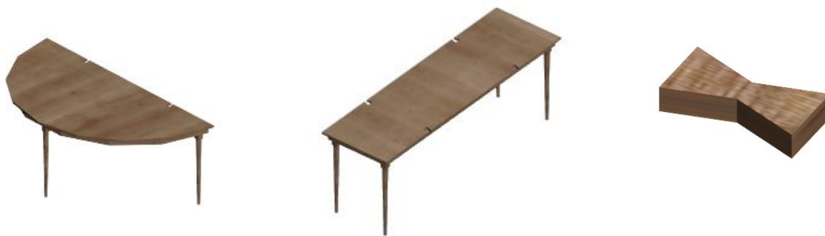
Figura 60- Peças que compõem a mesa, módulo semicircular, retangular, e peça de união, respetivamente.
