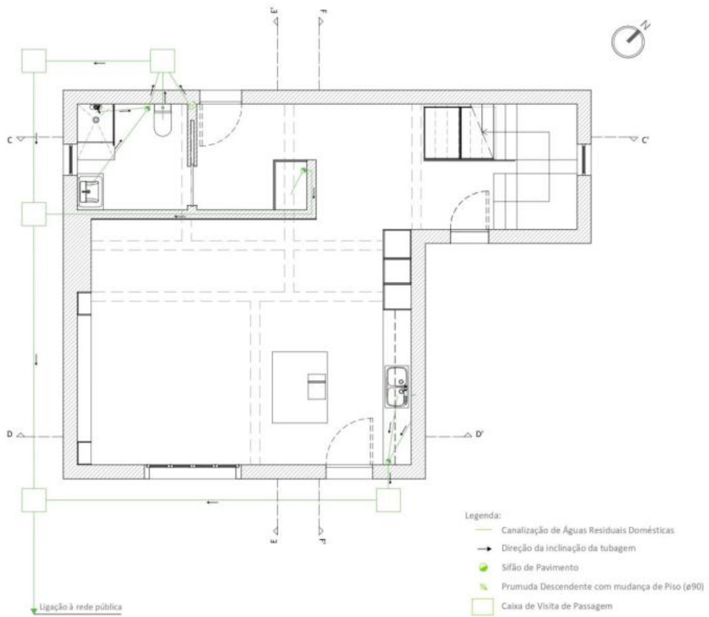
Figura 74 - Planta de Esgotos, Piso 0. Fonte: Autor
