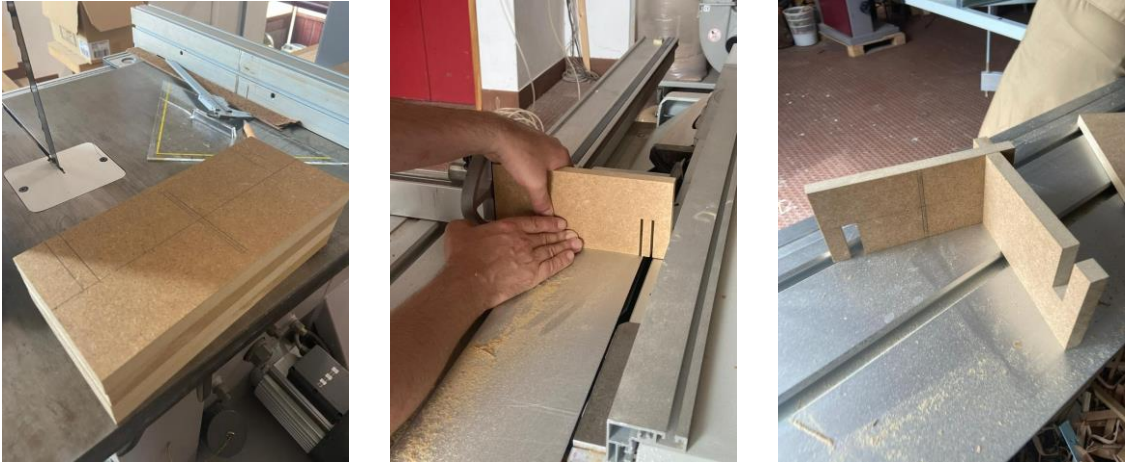
Figuras 79,80,81 – Imagens do Processo de Execução em Oficina, Marcação das peças, Cortes e Execução dos encaixes, Fonte: Autor
