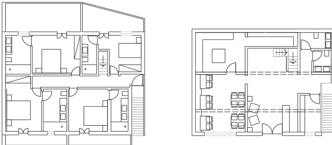
Figura 27- Primeira planta de proposta relativa ao piso 1 e rés do chão. Fonte: Tânia Tavares.
