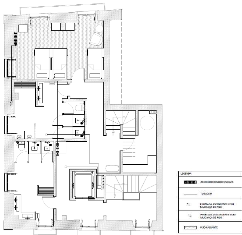
Figura 192 - Planta de Conforto Térmico - Piso 2
