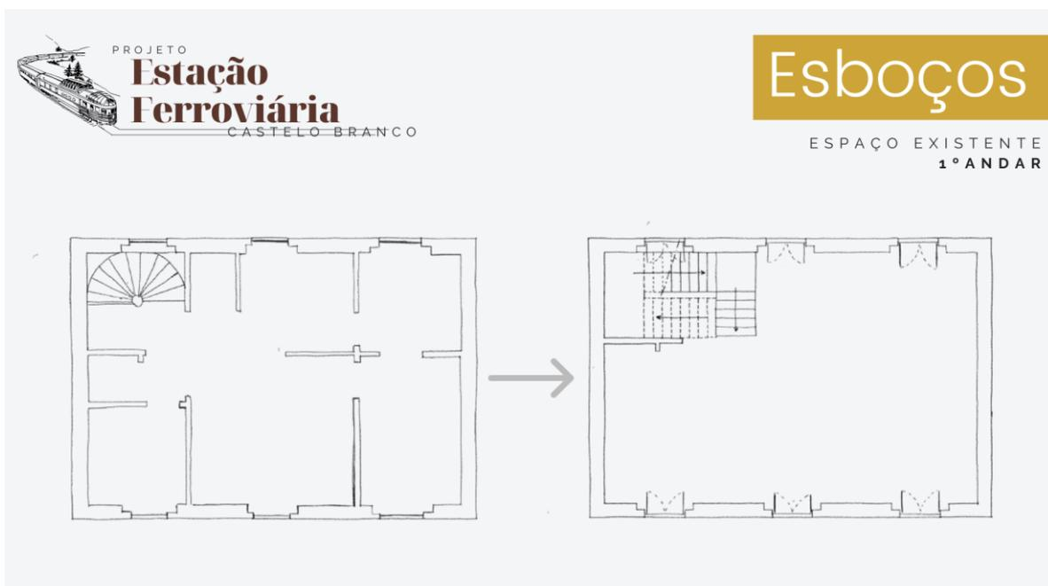
Figura 55 - Esboços da planta do 1º andar existente com possível alteração das escadas
