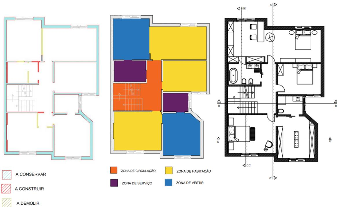
Neste piso comecei por demolir as paredes dos quartos da cliente e da filha, resultando daí uma divisão maior, que tornou possível juntar a zona de habitação com a zona de vestir. No quarto da cliente coloquei alguns revestimentos texturados nas paredes e ligado ao closet através de uma pequena passagem.
