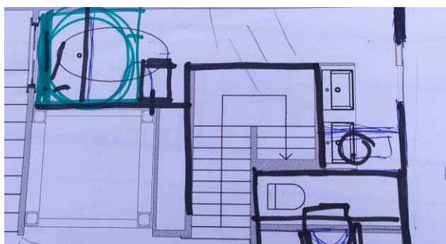
Figura 50. Pré-proposta do terceiro andar- instalações sanitárias
