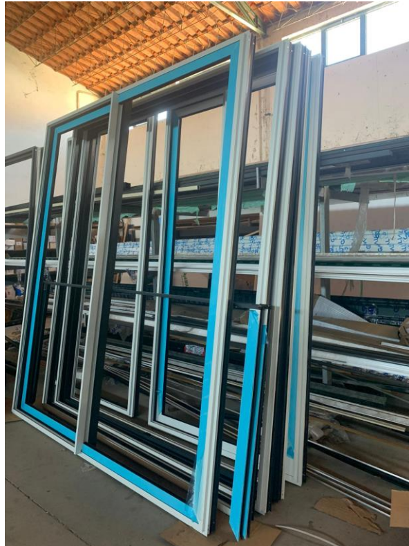
Figura 4 - Janelas de Alumínio (Fonte Autora)
