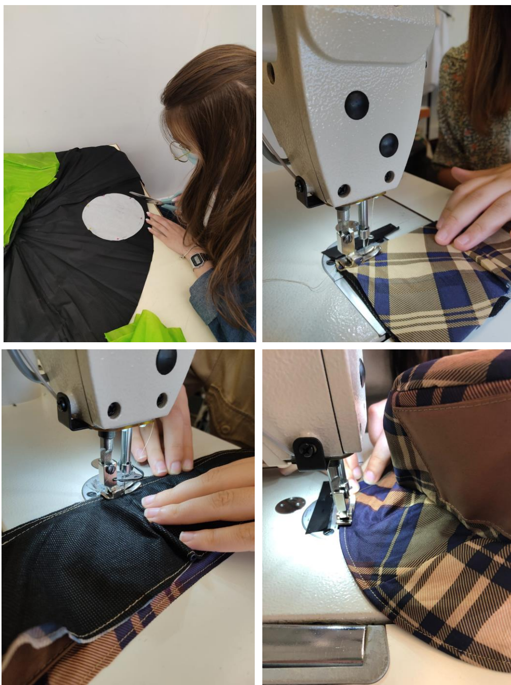
Figura 46 - Etapas da confeção do chapéu de cabeça.
