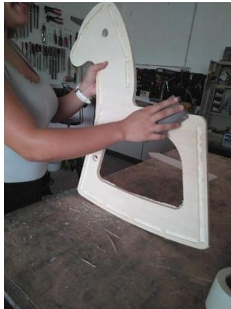
**Figura 22** - Retoques finais com lixa antes da colagem
