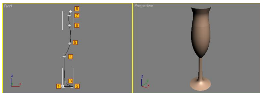
Figura 17- Spline / Patch representação de uma linha que origina um cálice. Box. Fonte: http://www.republicofcode.com/tutorials/3ds/spline_lathe_stealth/
