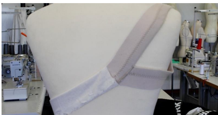
Figura 18 - Protótipo do forro final colocado no manequim
