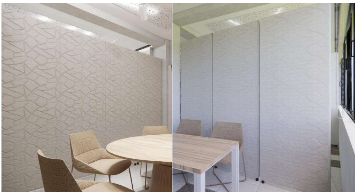
Figura 57 - Divisória acústica móvel na zona de escritório e reuniões. Fonte: Autor, 2026
