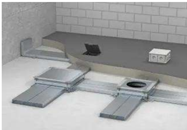
Figura 20 - Tubulações subterrâneas. Fonte: cableado estruturado sase, 2026
