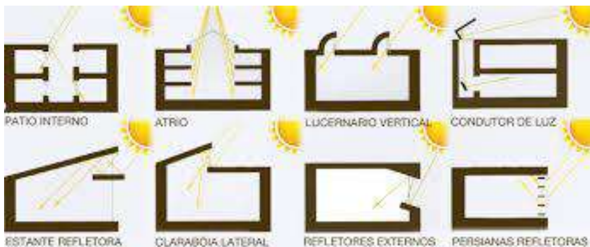
Figura 30 - Esquema de distribuição da luz natural em espaços profundos. Fonte: Ecoeficientes, 2026
