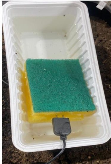
Figura 56 - Sensor de humidade do solo emergido em água
