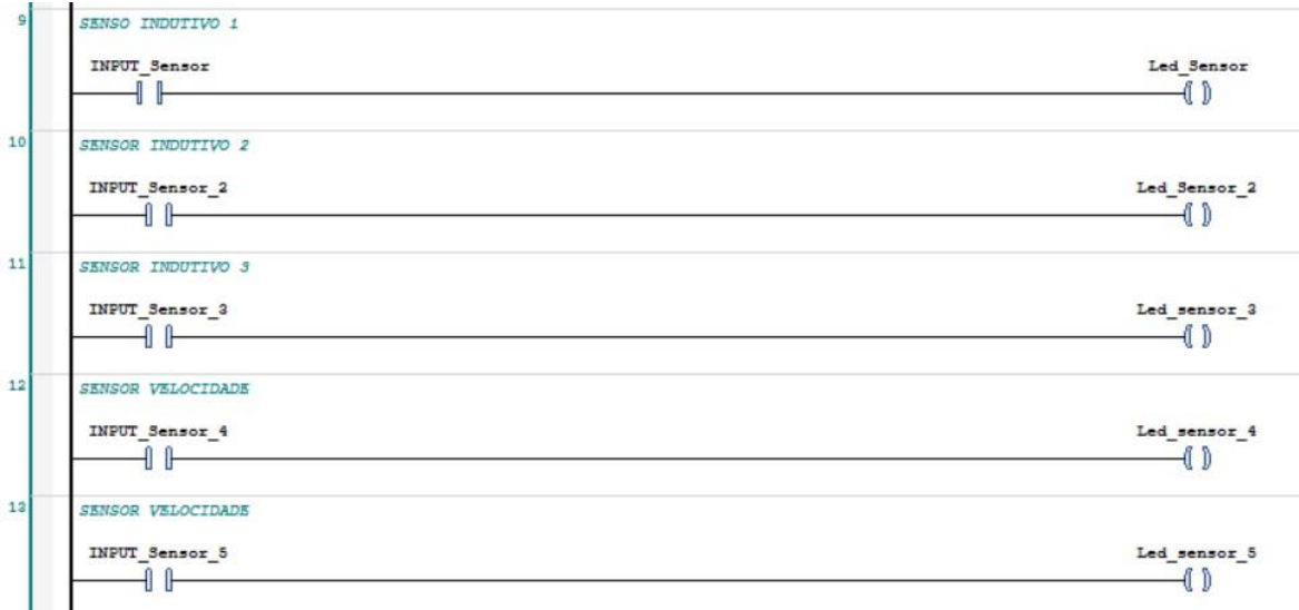
Figura 88 - Programação LADDER dos sensores indutivos.
