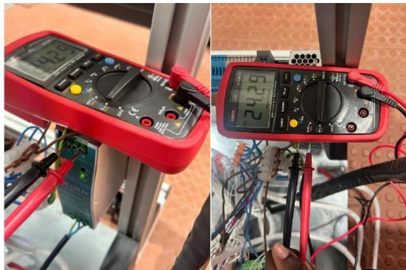
Figura 120 - Teste na fonte de 24V.
