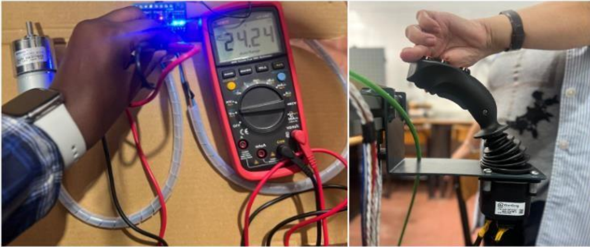
Figura 117 - Demonstração 1 da variação da tensão entregue ao driver mosfet com o manuseio do joytik_2.
