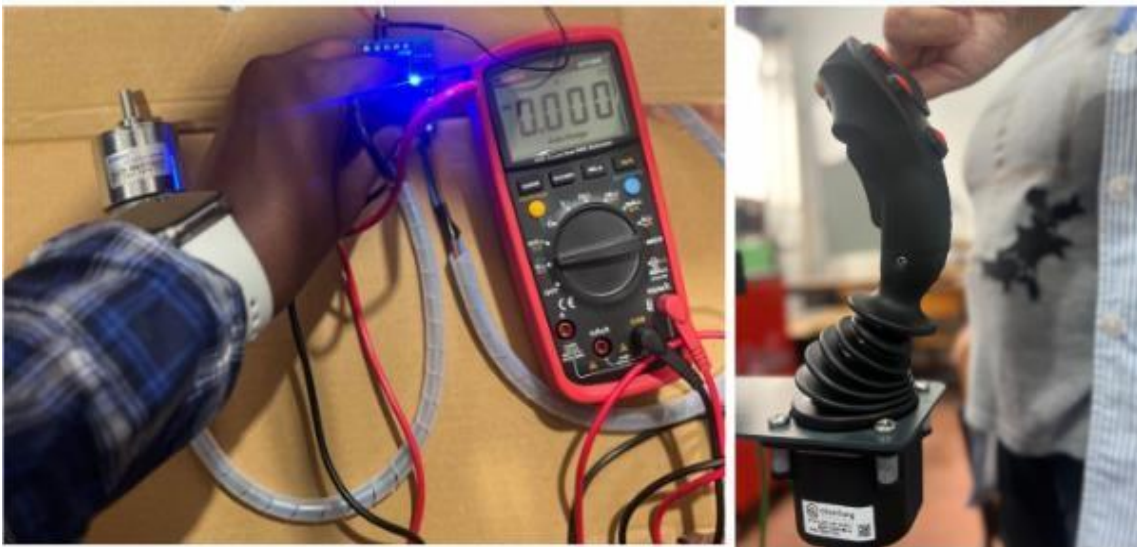
Figura 118 - Demonstração 2 da variação da tensão entregue ao driver mosfet com o manuseio do joytik_2.
