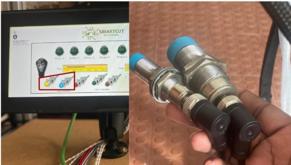
Figura 106 - Testando o sensor indutivo NF na prática, o led acende quando distante do metal.
