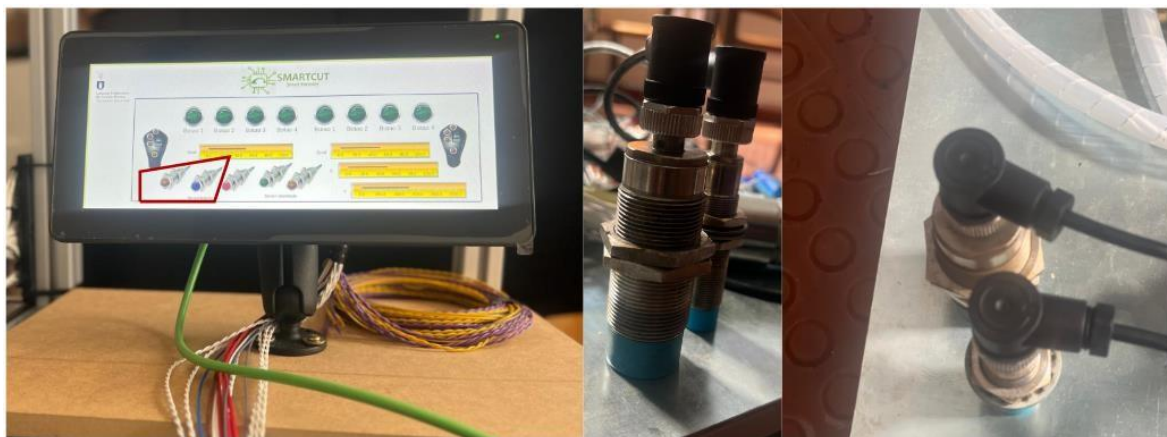
Figura 107 - Testando o sensor indutivo NF na prática, o led apaga quando próximo do metal.
