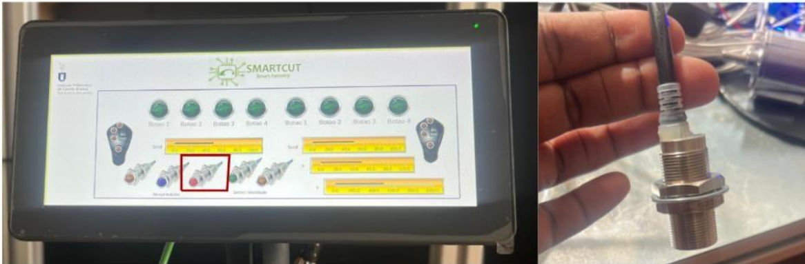
Figura 108 - Testando o sensor indutivo NA, na prática o led apaga quando distante do metal.
