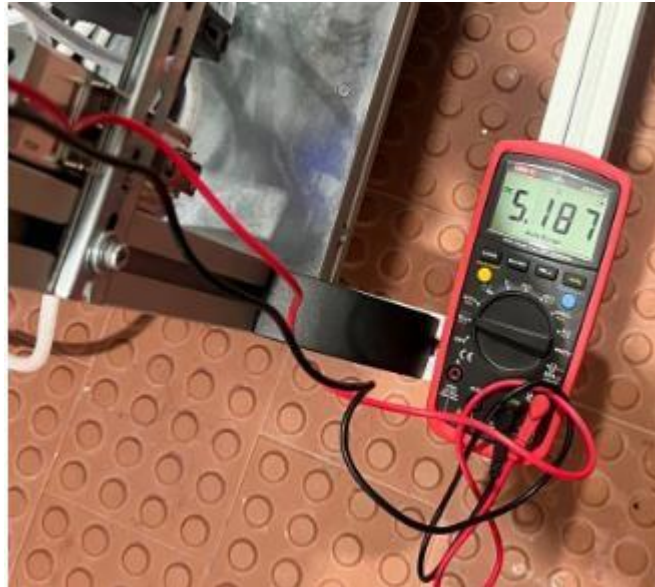
Figura 119 - Teste na fonte de 5V.
