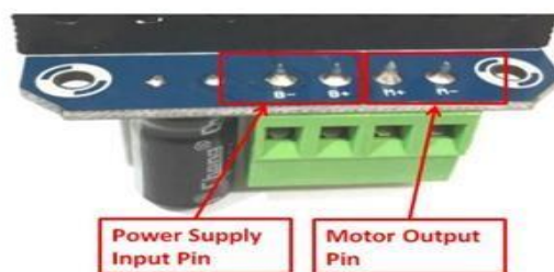
Figura 13 - Ligações da alimentação do motor (24V).
