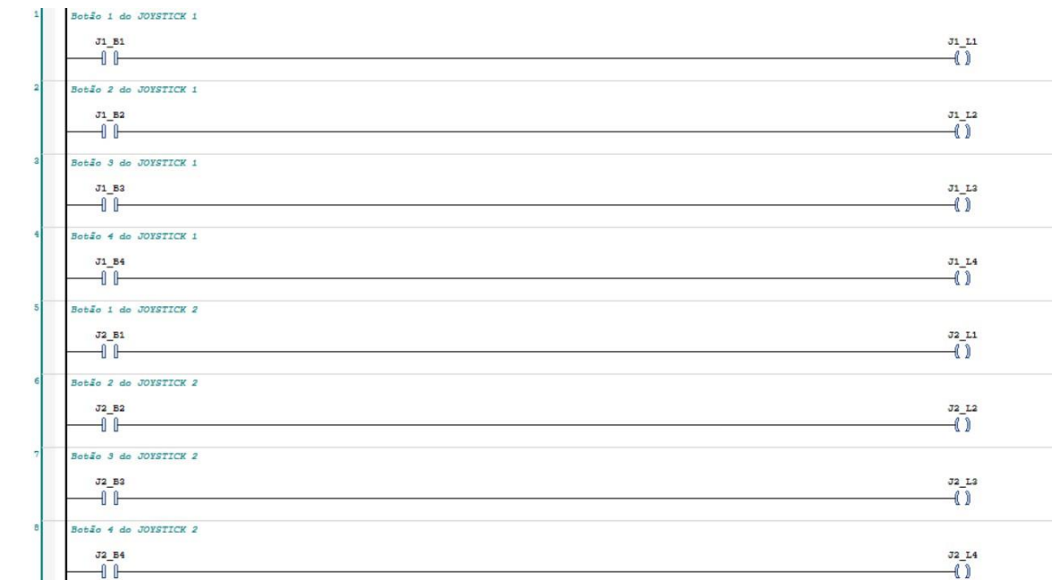
Figura 83 - Programação em LADDER dos botões dos joysticks.
