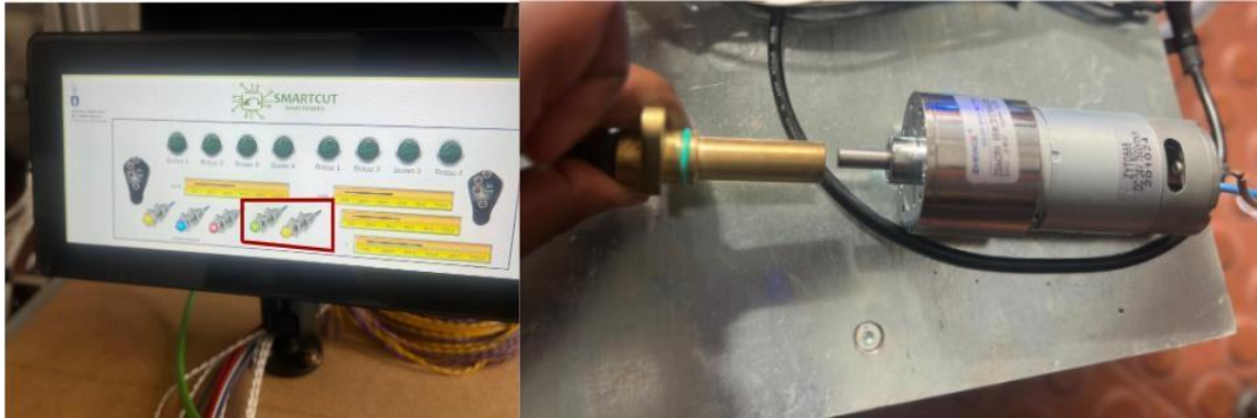
Figura 111 - Testando o sensor de velocidade na prática, os leds oscilam entre si quando próximo do metal
