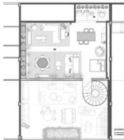
Figura 88- Planta baixa da Loja Fólío, mostrando o posicionamento do mezanino. Fonte: Archdaily Arch.lab (2021)
