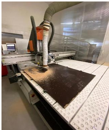
Figura 8- A placa está posicionada no tabuleiro da máquina de corte CNC
