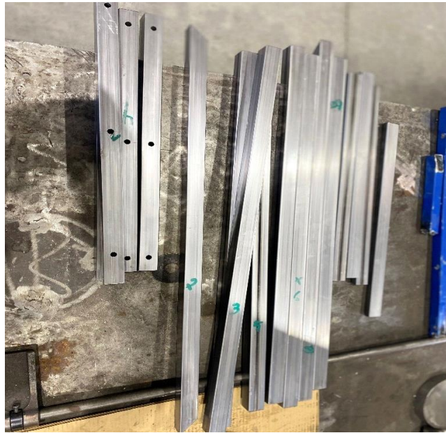
Figura 26 - Tubos já cortados e furados
