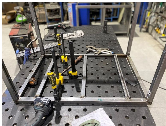
Figura 25 - Bancada em construção
