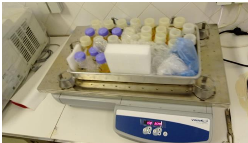
Figura 1 - Agitador orbital com os recipientes contendo a solução sintética de cromo e os materiais adsorventes.
