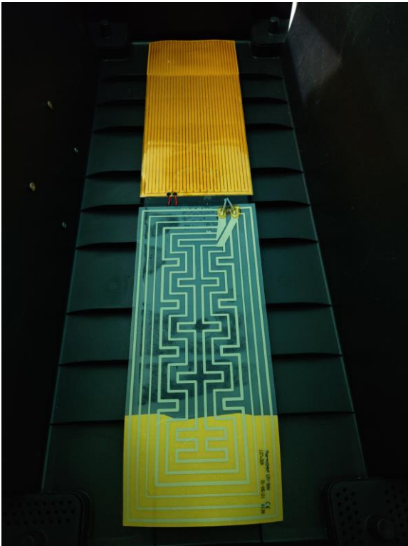
Figura 47 - Resistências de aquecimento adesivo na base do interior da estufa
