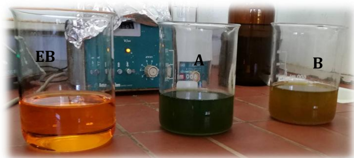
Figura 7 - Determinação da matéria orgânica (EB; A - amostra com teor elevado de matéria orgânica; b - amostra com teor baixo de matéria orgânica.
