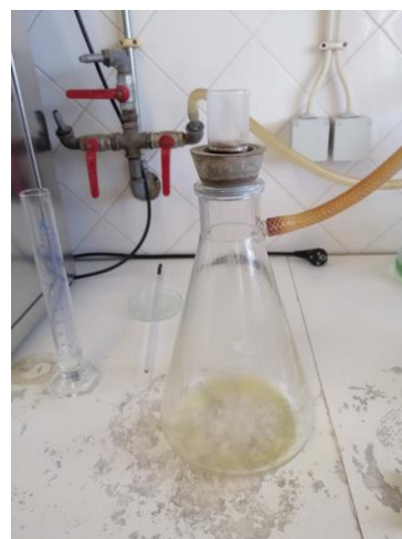
Figura 21 - Filtração de cadinho com acetona com o auxílio de uma bomba de vácuo (foto LNAA/2014)
