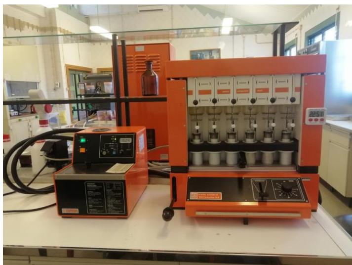
Figura 19 - Sistema Soxtec para determinação da gordura das amostras de alimentos (Tecator Soxtec System HT, 1043 Extraction Unit, 1046 Service Unit) (foto LNAA/2024)
