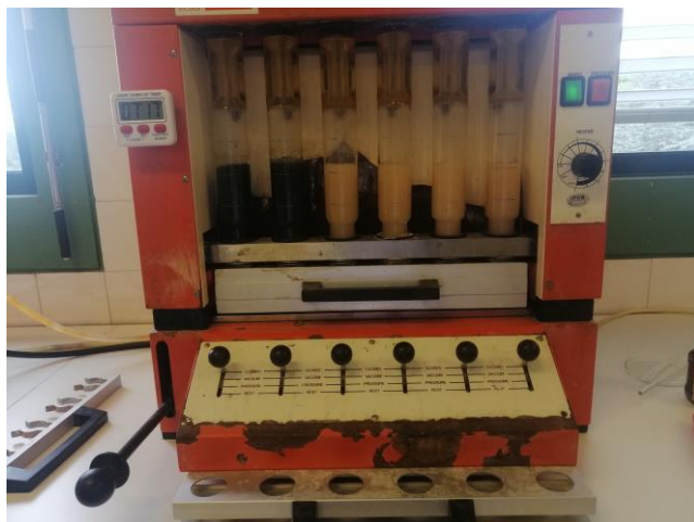
Figura 20 - Unidade de extração Fibertec para determinação da fibra das amostras de alimentos (foto LNAA/2024)
