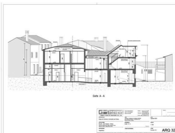
Figura 27 - Corte AA'. Fonte: GABICOL
