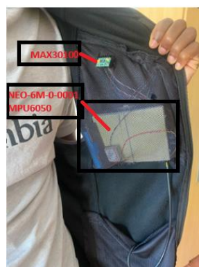
Figura 62 - Localização dos sensores MX30100, NEO-6M-0-0001 no Colete
