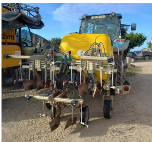
Figura 16 - Aplicador de herbicida na cultura do tomate em extensivo
