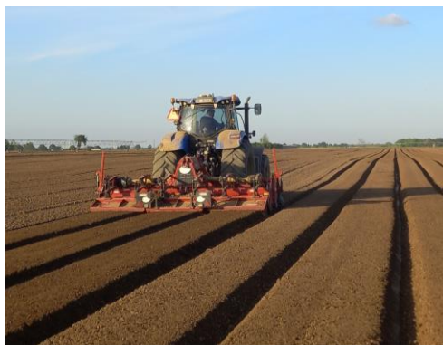
Figura 14 - Armação dos camalhões
