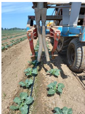
Figura 7 - Adubador de fertilizantes sólidos preparado para adubação de cobertura
