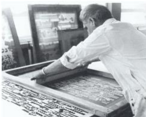
Figura 62 - Técnica de estampagem à Lionesa. Fonte: Adaptado de Sebenta Design de Têxtil I.
