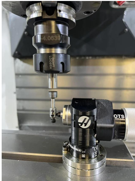
Figura 31 - Sistema de medir a ferramentas por apalpação de forma automática.
