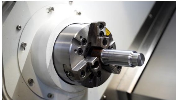
Figura 27 - Sistema de fixação de peças no processo de torneamento, denominada de bucha de 3 grampos.
