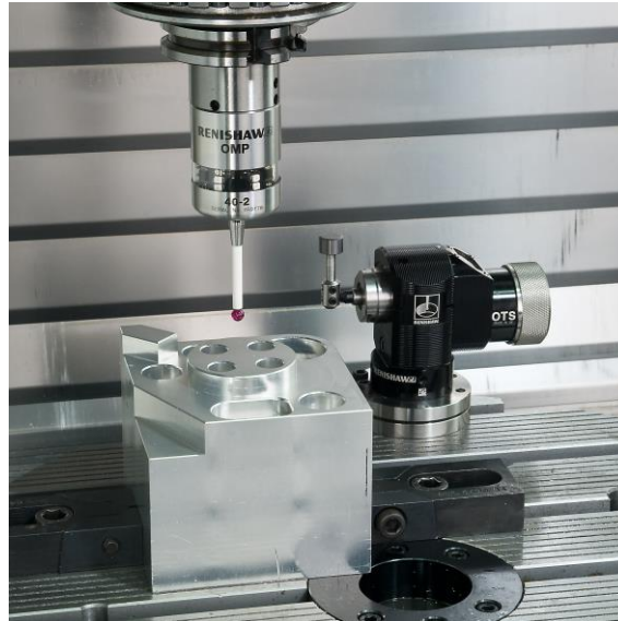
Figura 28 - Sistema para efetuar o zero da peça por apalpação de forma automática.
