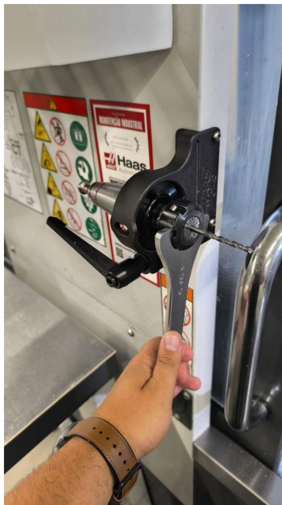
Figura 29 - Sistema de aperto das ferramentas de corte no sistema de fresagem, denominado de cone porta pinças.
