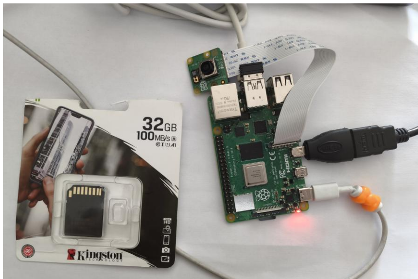
Figura 6 - Componentes de hardware utilizados na componente edge do protótipo: Raspberry Pi 4 Model B, Raspberry Pi Camera Module 3 e cartão microSD
