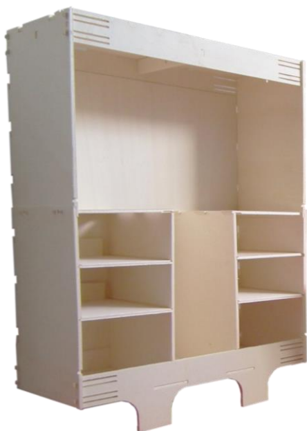
Figura 34. Maqueta do roupeiro realizada em CNC.
