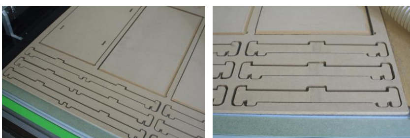
Figura 14 - Corte das peças na CNC finalizado
