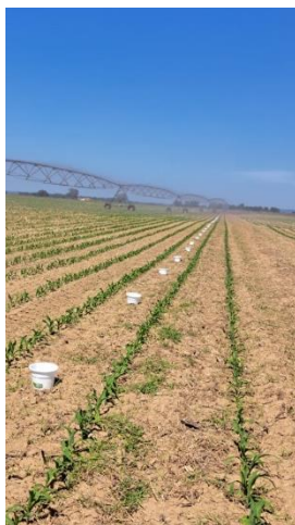
Figura 21 - Ensaio de uniformidade de rega em pivot
