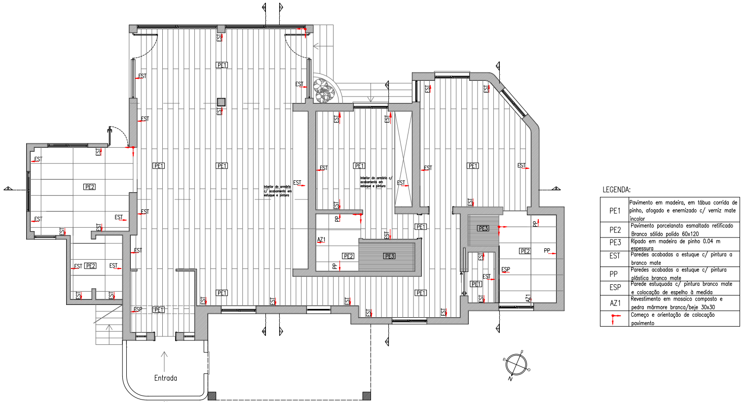
Fig. 57 - Planta de Revestimentos/Acabamentos;
