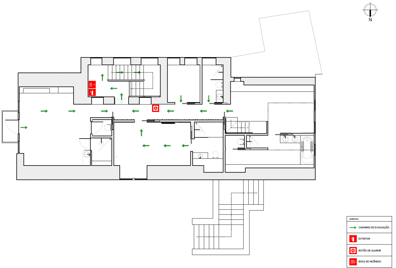
Figura 198 – Planta de Incêndio, Alojamento Loureiro, Piso
