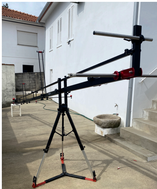
Figura 9 - Montagem de grua de vídeo
