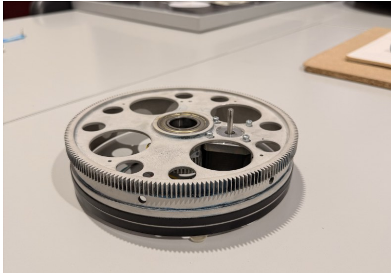
Figura 27: Base do Helióstato.
