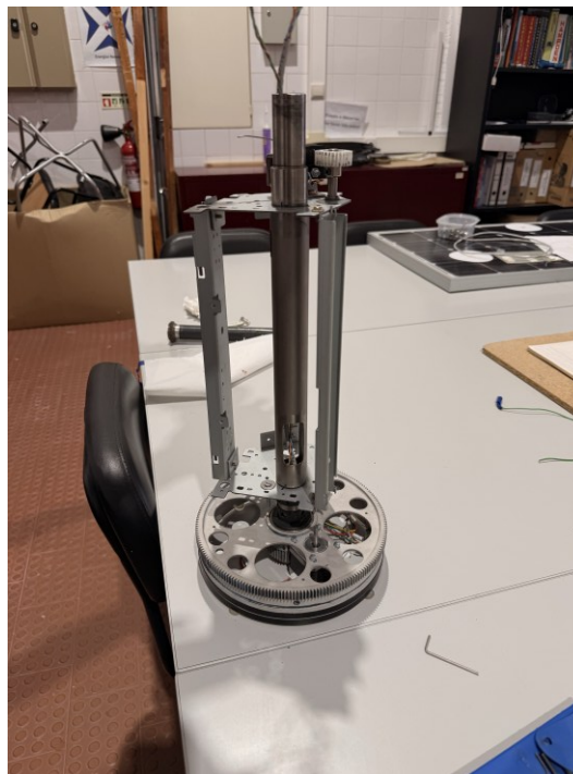
Figura 28: Mastro do Helióstato.
