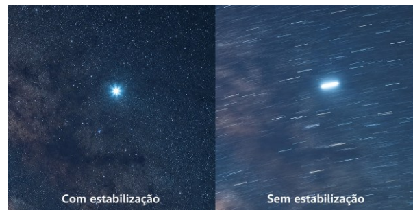
Figura 19: Imagem de telescópio com e sem mecanismo do helióstato.
