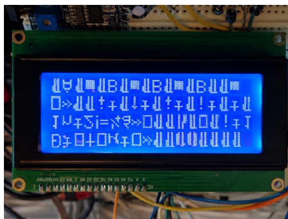
Figura 42: Ruído eletrónico num display LCD.
