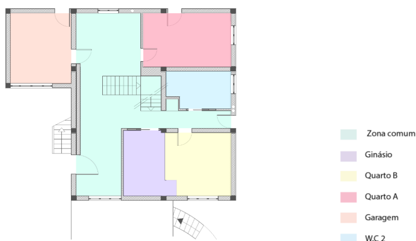
Figura 18- Planta de zonamento do rés do chão.
