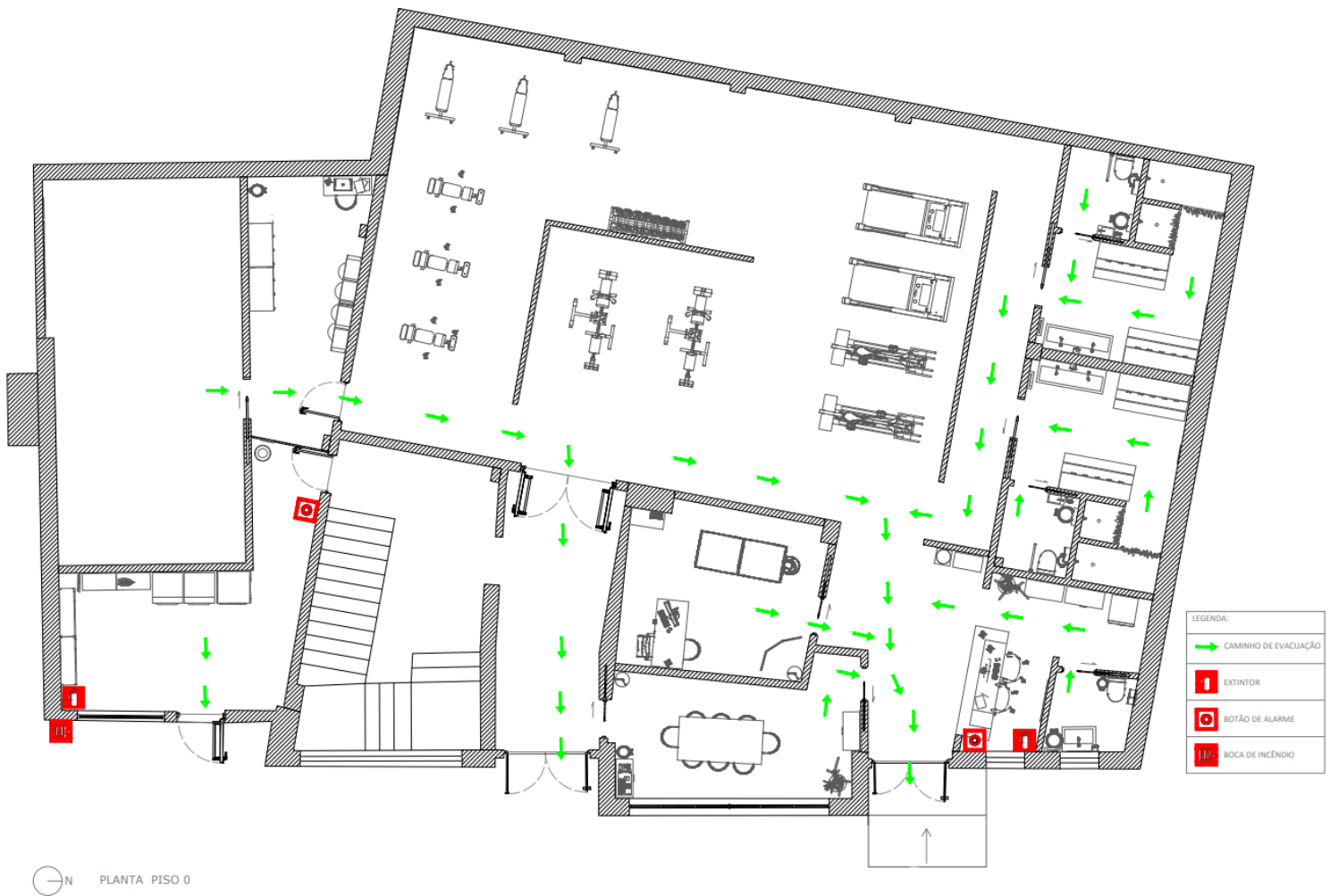
Figura 148- Planta de Incêndios, Fonte: Autor
