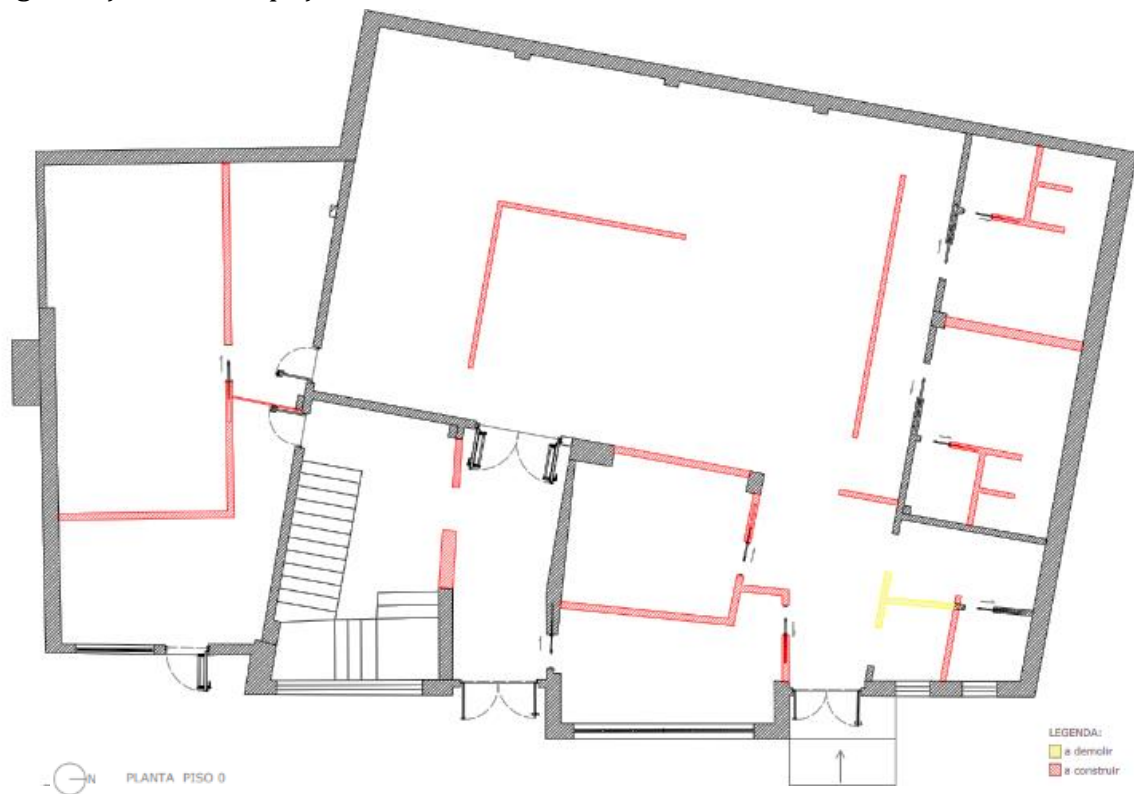
Figura 102- Planta de demolição
