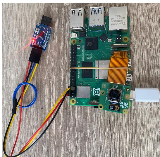
Figura 4 - Integração dos sensores no Raspberry Pi 5.
