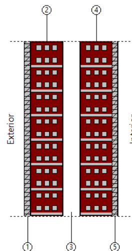
Figura 65: Composição das paredes exteriores.
