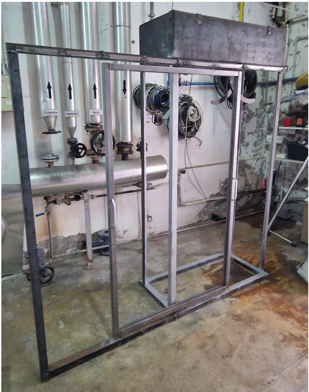
Figura 3 - Estrutura já com extensão de comprimento e porta movel apoiada na guia
