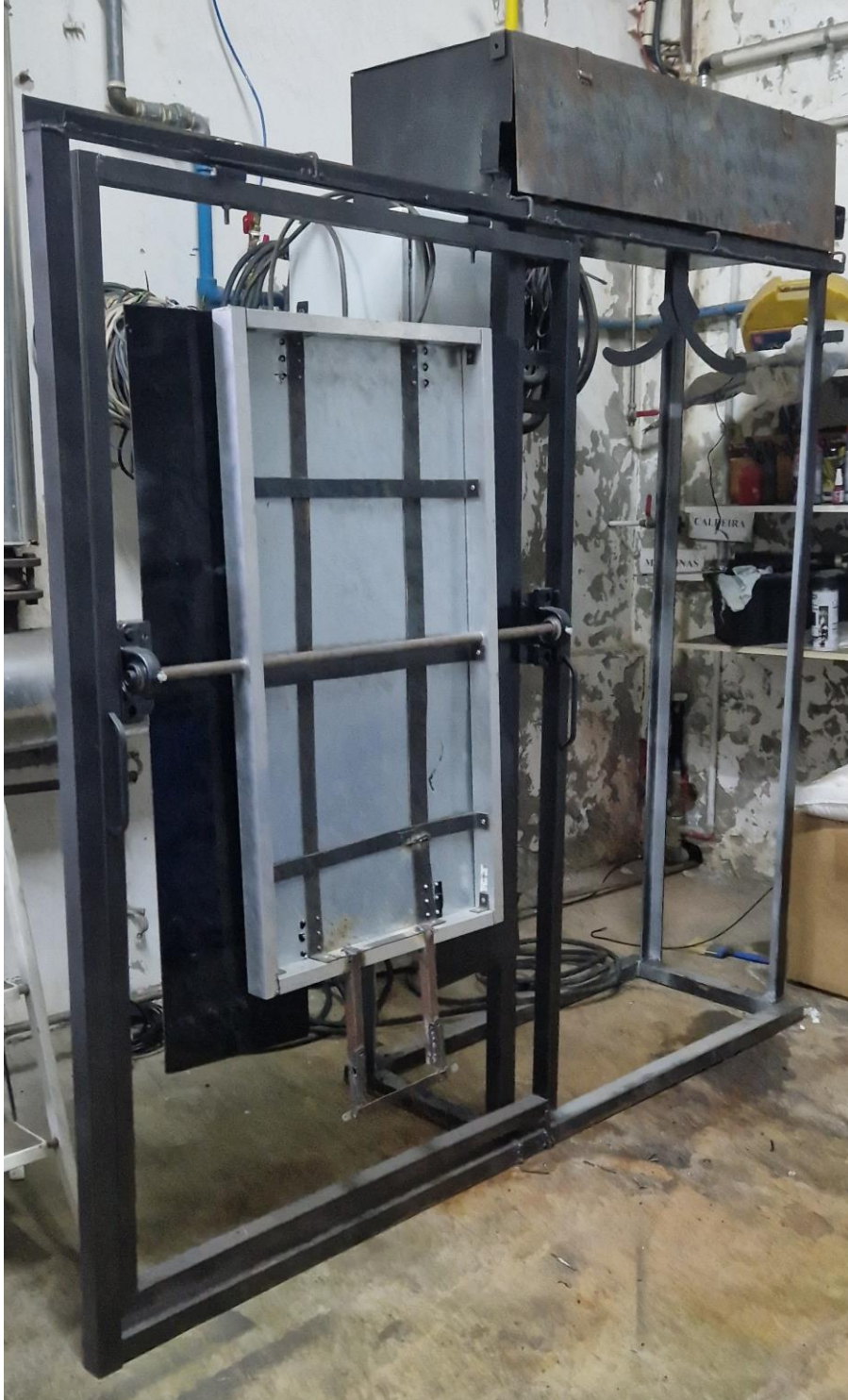
Figura 4 - Estrutura já com a mesa movel colocada, fixa em duas chumaceiras
