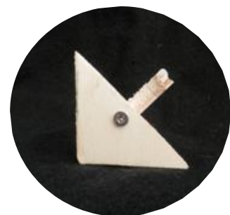
Imagem 28- Exemplo de encaixe com parafuso philips.
