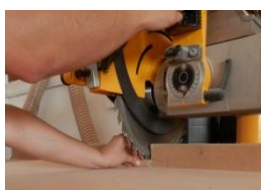
Imagem 19- Rebaixos das cavilhas com Serra Circular.
