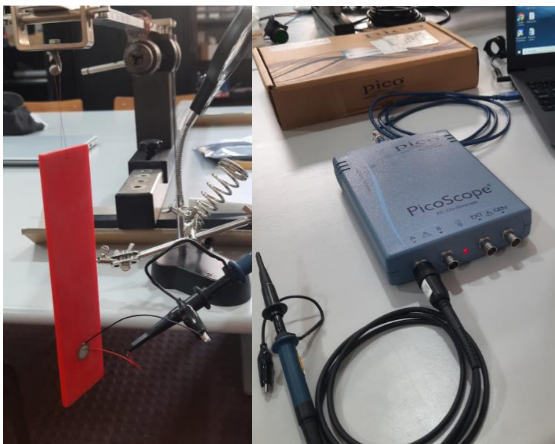
Figura 14 - Provete suspenso e pronto para o ensaio de flexão
