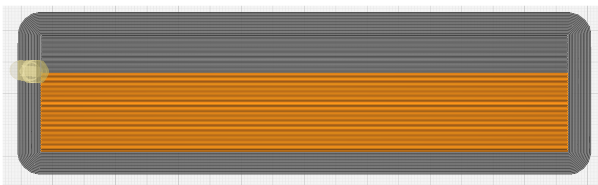
Figura 4 - Simulação da impressão do provete 1 a 90°
