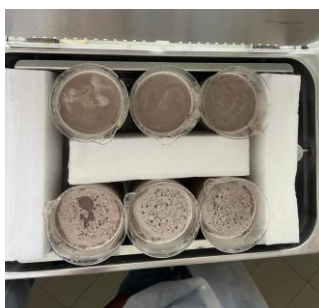
Figura 8 – Vista superior dos copos de precipitação em banho termostaticado (imagem do autor).
