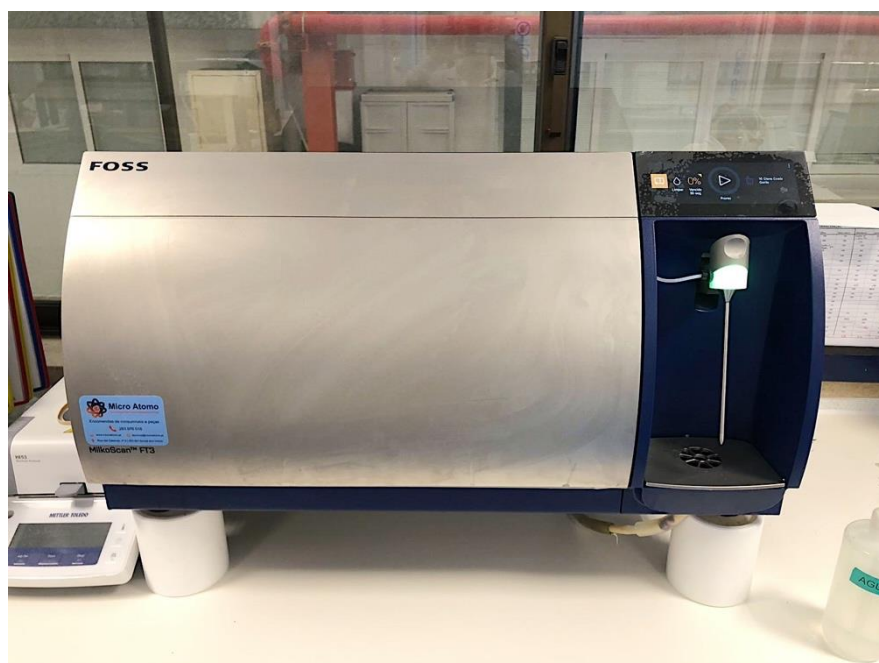
Figura 25: MilkoScan FT3 para determinação de teor de gordura e proteína
