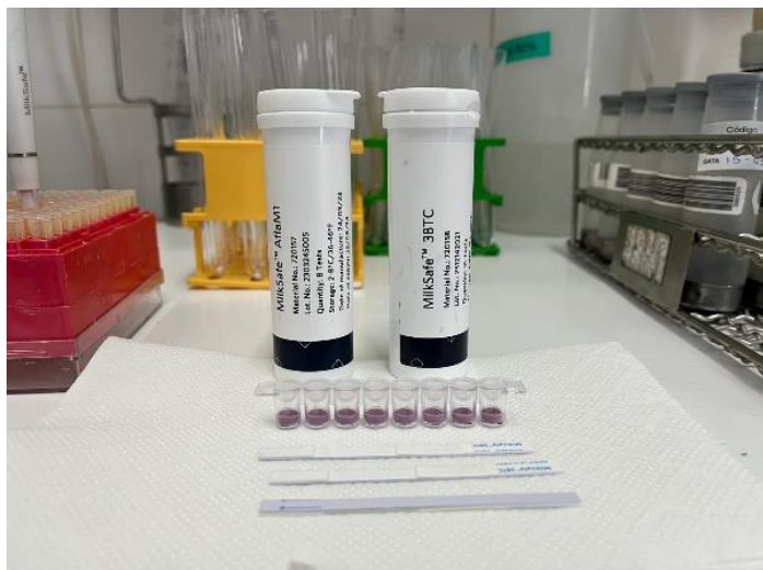
Figura 23: Testes (micropoços e tiras) na determinação de Inibidores/Aflatoxinas
