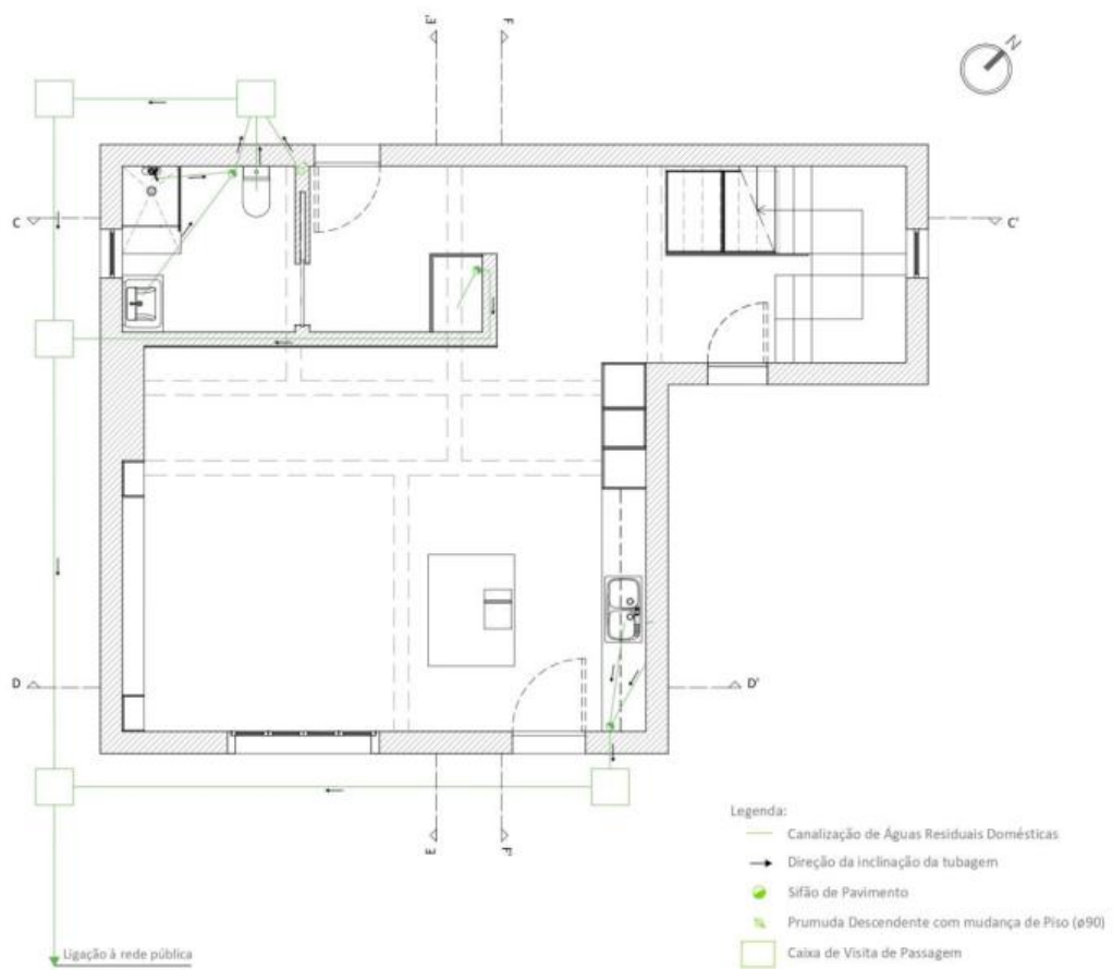
Figura 74 - Planta de Esgotos, Piso 0. Fonte: Autor
