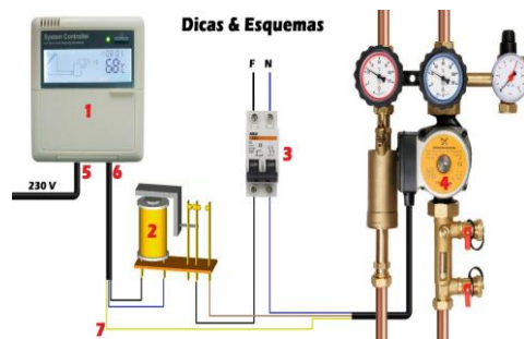
Figura 10: Sistema de controle de SST.
