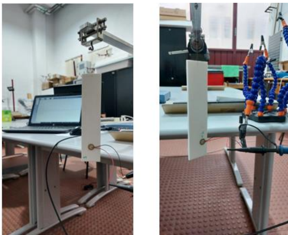
Figura 20 - Provete pronto para ensaio de flexão (esquerda) e provete pronto para ensaio de torção (direita)
