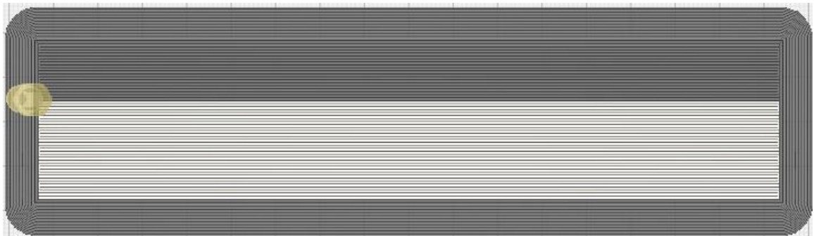
Figura 8 - Simulação de impressão no Cura do provete de 90°
