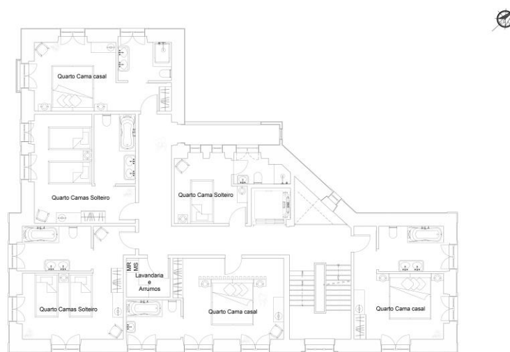
Figura 30 - Planta de Zonamentos Piso 1. Fonte: Autor
