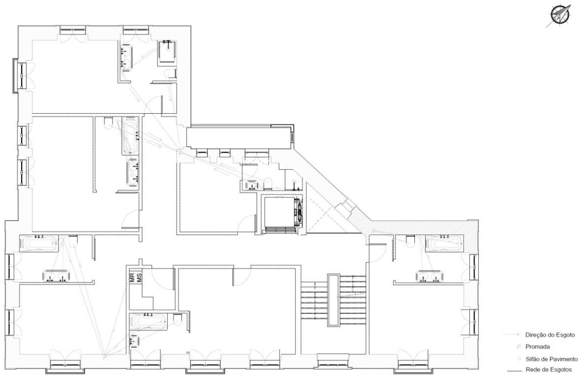
Apêndice 25 - Planta de Esgotos Piso 1. Fonte: Autor
