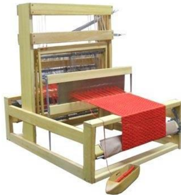
Figura 15 - Tear de padronagem (fonte: https://juliotear- artemadeira.com.br/tear-patronagem-em-sao-paulo/index.html )
