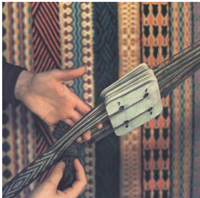
Figura 13 - Tear de cartão (fonte: http://www.tecelagemanual.com.br/cartao/index.htm )
